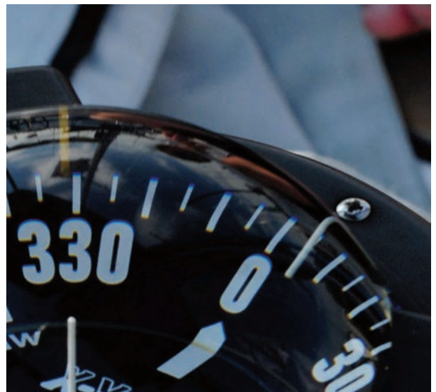
Als Steuerkompass geeigneter Magnetkompass
