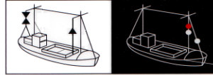
Fischereifahrzeug mit Treibnetz, das schon mehr als 150 m vom Schiff ausgebracht wurde
