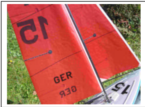
Großsegelvorliek zu straff gespannt
