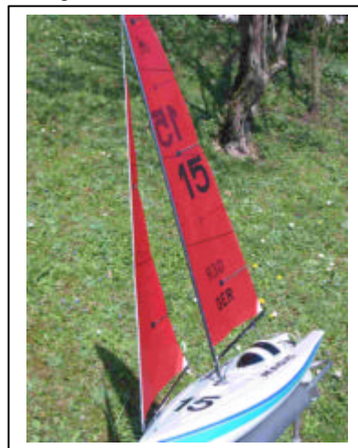
Bilder: Achterliekspannung / -rundung beim Vorsegel: Trimmung durch Dirk
