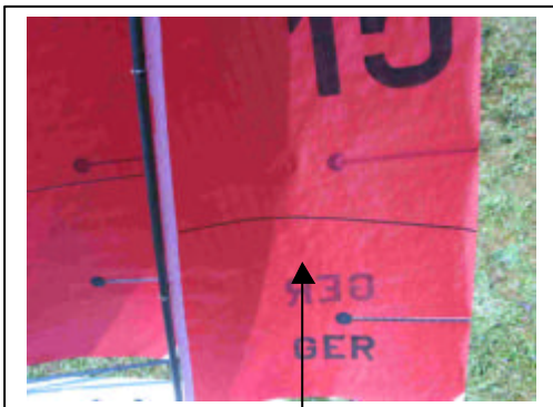
Kaum Spannung = max. Profiltiefe geht gegen Segelmitte
