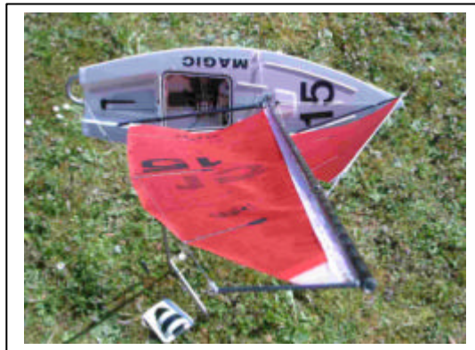
Großsegel-Unterliek schon zu bauchig (hier ist daneben auch die Vorliekspannung zu gering)
