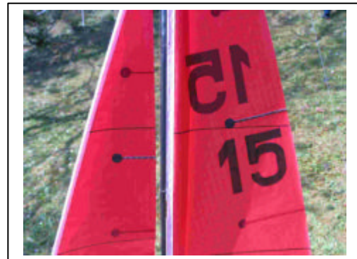
Großsegelvorliek zu straff gespannt
