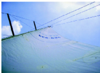
Großsegel durch Mastbiegung flach und offen getrimmt
